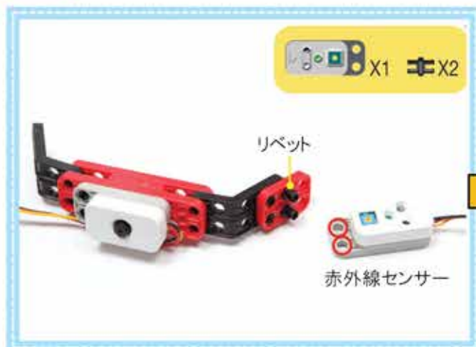
45 2X3パネルに赤外線センサーをつける
