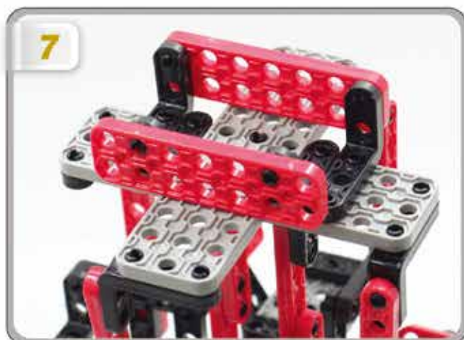
Lブラケットに 1 で外した2X7パネルをつける
