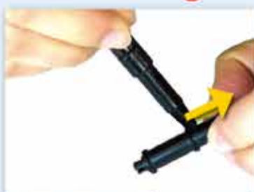
サポートの横のすき間に分かいツール B を入れて矢印方向におして分かいする
